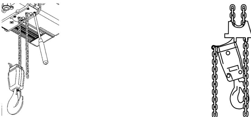
**Diagrama 6-10:** Desmontaje de la guía de cadena del polipasto de caída doble.
