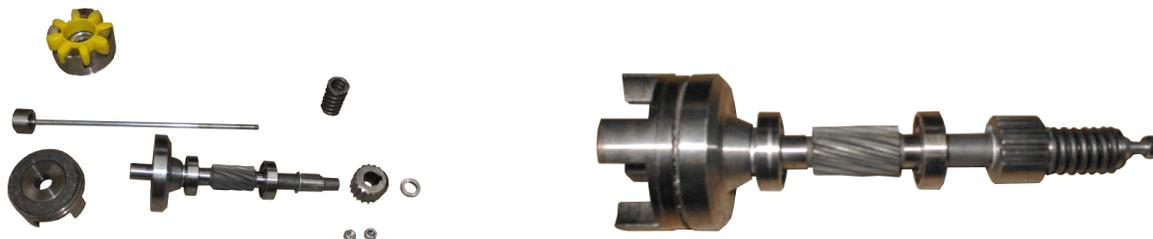
**Diagrama 6-19.** Embrague deslizante desmontado (izquierda) y montado (derecha).
