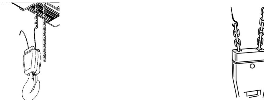
**Diagrama 6-9.** Montaje de la cadena de carga, versión de caída doble.
