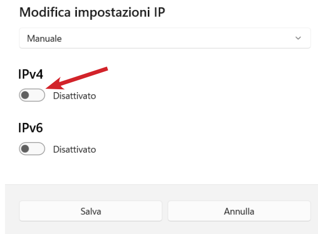
Diagramma 4B-9. Modifica impostazioni IP - Attivazione IPv4.
