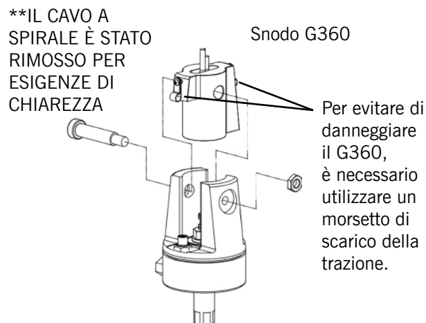
Diagramma 2-5B1. G360, bullone con collare e cavo a spirale
