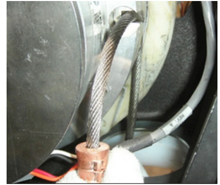
Diagramma 7-6. Inserire la fune dall'attuatore attraverso l'apertura in basso e formare un'ansa da inserire nel canale radiale.
